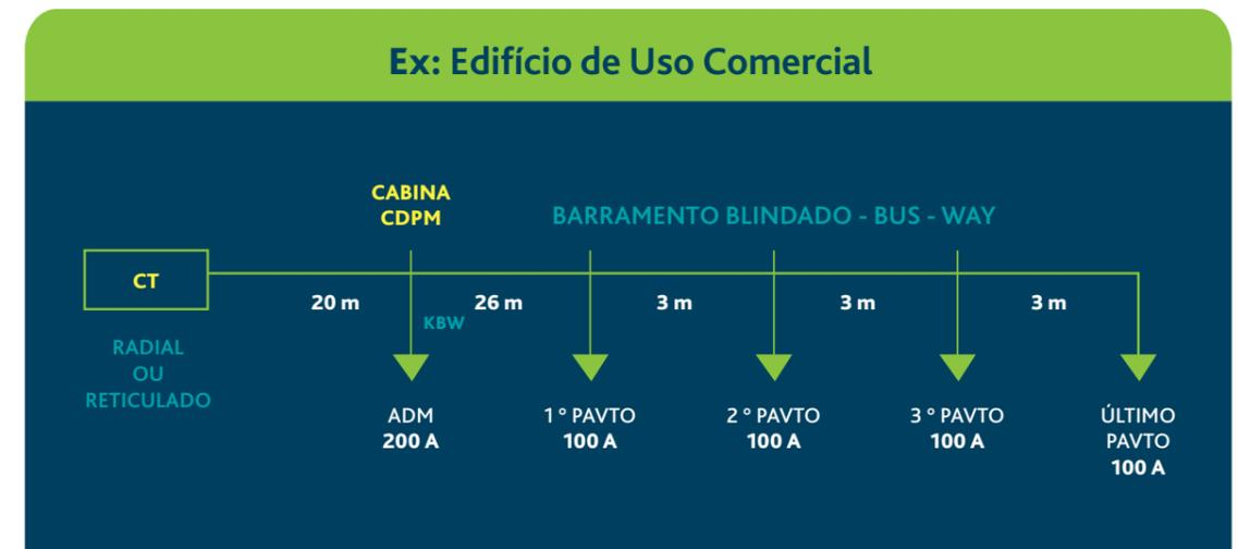
Utilizando parâmetros de queda de tensão estimados pelo projetista para o barramento, por exemplo:
